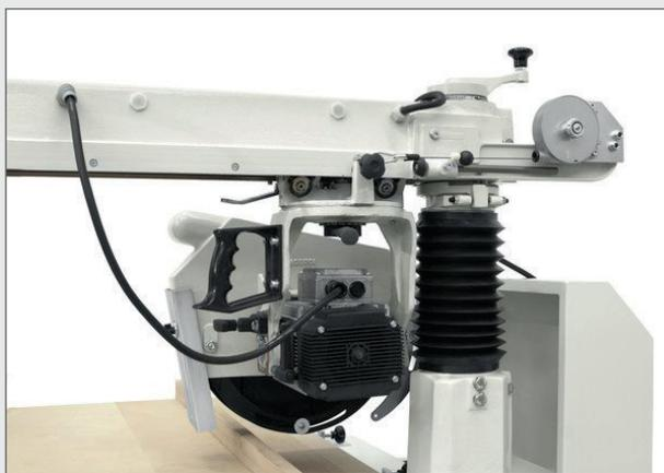
Por la parte interior de la protección regulable, se colocarán unos listones de madera, que eviten la introducción, por la sierra de disco, de virutas en el interior de la protección.
